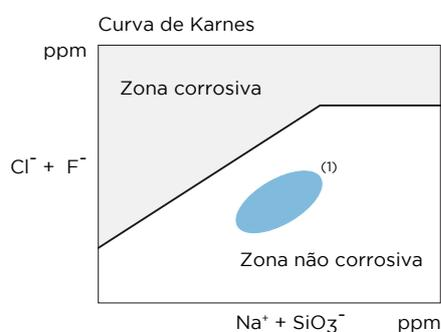
Nota: as análises químicas de iões, realizadas segundo as normas ASTM C-795 e C-871 demonstram que os produtos de lã de vidro ISOVER não provocam a corrosão no aço, uma vez que a relação dos iões Cl<sup>-</sup> + F<sup>-</sup> relativamente aos iões Na<sup>+</sup> + SiO<sub>3</sub><sup>-</sup> situa-se na parte inferior da Curva de Karnes.
