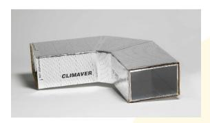
Painel rígido de lã de vidro **ISOVER**, de alta densidade, revestido na parte externa com uma folha de alumínio mate reforçada com papel kraft e malha de vidro, que actua como barreira de vapor, e na parte interna com uma folha de alumínio mate reforçada com papel kraft. Incorpora um véu de fibra de vidro em cada uma das faces para proporcionar maior rigidez.
