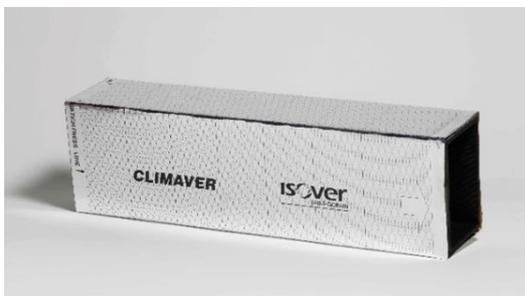
Painel rígido de alta densidade de Lã Mineral ISOVER, revestido na superfície exterior com uma folha de alumínio reforçada com papel kraft e malha de vidro, que actua como barreira de vapor, e na superfície interior, com tecido neto de vidro reforçado, de cor negra, de grande resistência mecânica.
