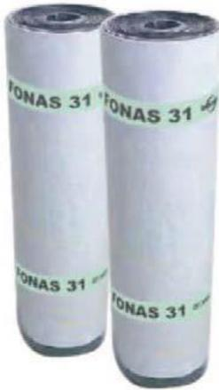
Feltro em fibra de poliéster de elevada gramagem acoplado a uma membrana betuminosa munida de uma aba autocolante para selagem das juntas, o que evita a formação de pontos de contacto entre a betonilha e a laje (pontes acústicas).
