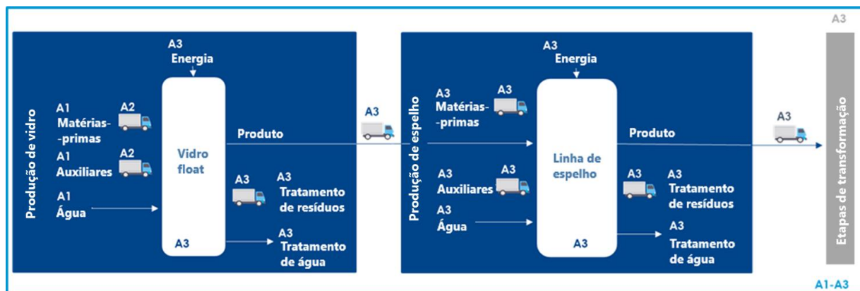
Figura 1: Passos relevantes da ACV para MIRALITE® PURE. As etapas a azul são declaradas nesta DAP, as etapas a cinzento não são declaradas.
