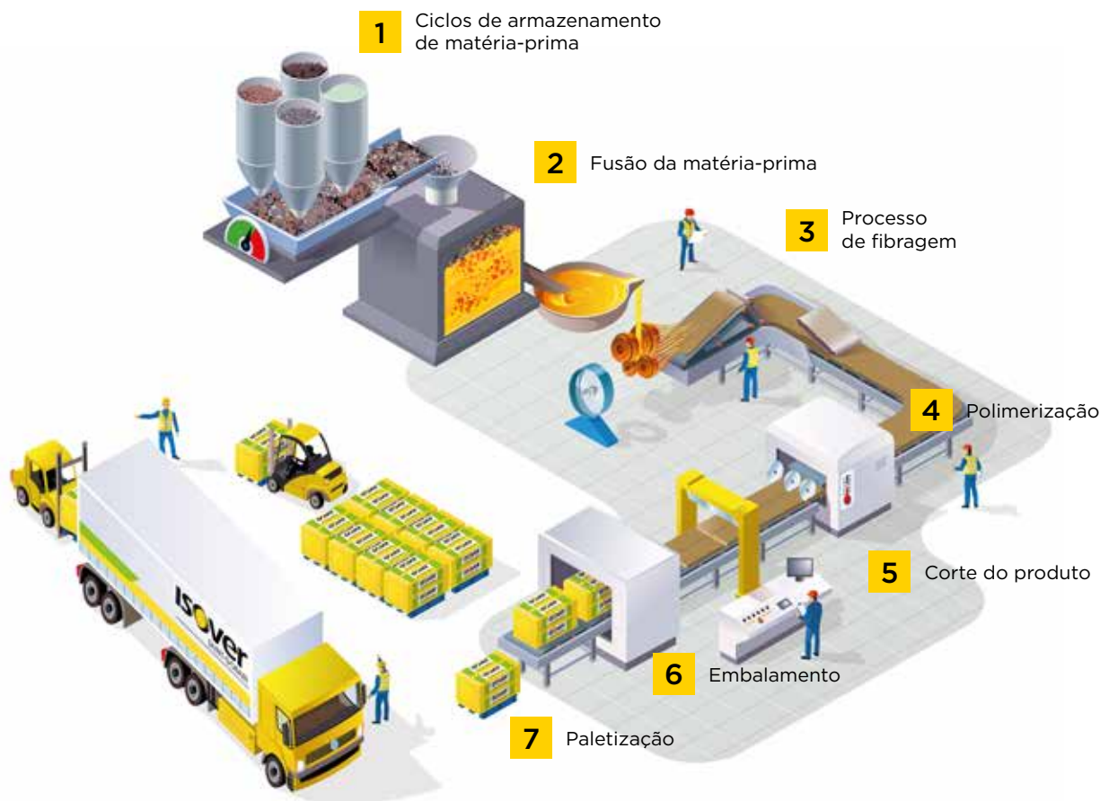
■ Fig. 2. Processo REX. Processo de fabricação de lãs de rocha.
